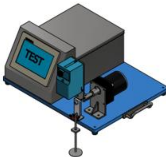
Gambar. 4 Desain Mesin Uji Mikro Fatik Tipe Cantilever Rotating Bending Load Dengan Kontrol Human Machine Interface
