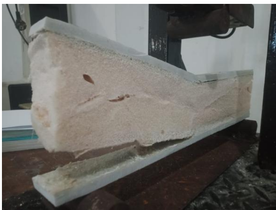
Gambar 8. Kegagalan uji bending
