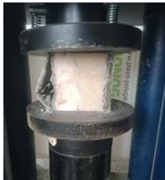
Gambar 10. Kegagalan uji kuat tekan
