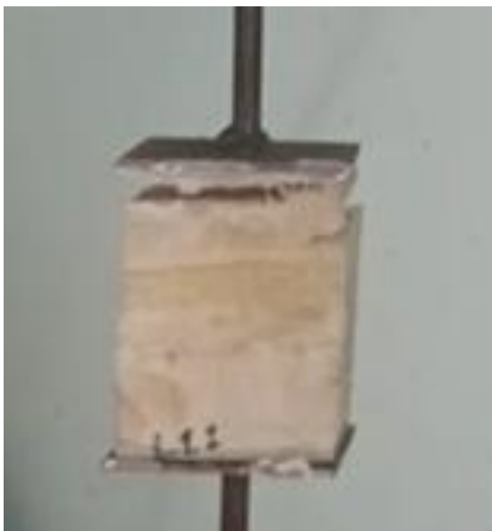
Gambar 12. Kegagalan uji tarik
