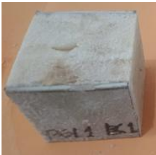
Gambar 4. Spesimen uji kuat tekan
