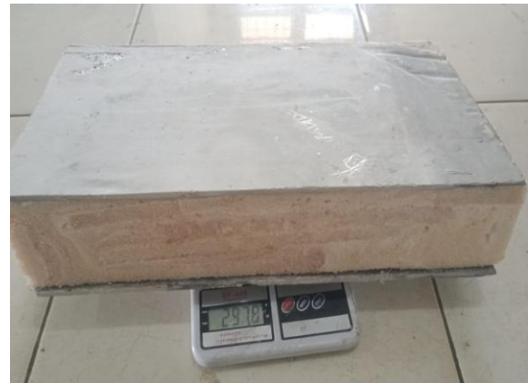
Gambar 2. Penimbangan specimen uji densitas
