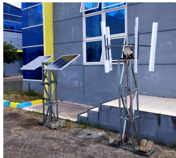
Gambar 4. Hasil manufaktur prototipe pembangkit listrik hybrid angin-surya
