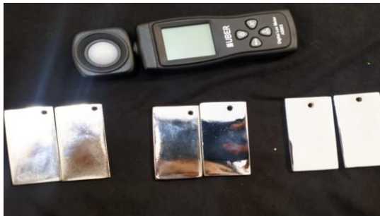
Gambar 3. Hasil elektropalting nikel, peneliti sebelumnya, non filter, dan penggunaan filter
