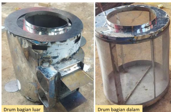
Gambar 2. Drum bagian luar dan dalam pada penering
