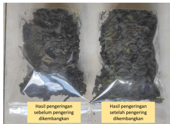
Gambar 10. Hasil pengeringan daun singkil menggunakan pengering sebelum dan setelah dikembangkan
