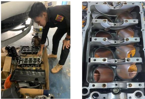
Gambar 1. Pembongkaran mesin speedboat Sumber : Peneliti, 2024
