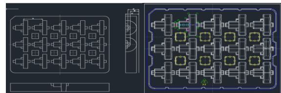
Gambar 2. menunjukkan simulasi desain mold tray
