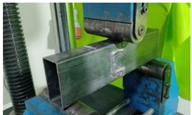
Gambar 7. Pelaksanaan pengujian bending Berdasarkan hasil pengujian penetrant yang aman, maka pengujian
