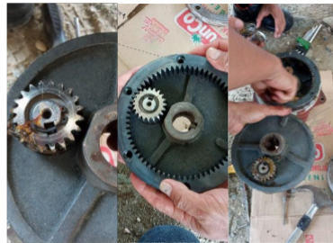
Gambar 13. Pembersihan dan pelumasan
