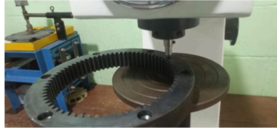
Gambar 11. Pengukuran kekerasan dengan Rockwell Hardness Tester
