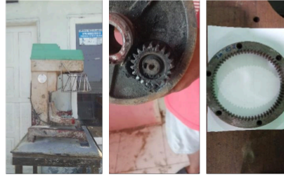
Gambar 2. Inspeksi mesin dan komponen yang rusak
