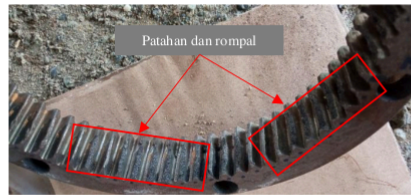
Gambar 4. Visualisasi cacat rompal/patahan roda gigi
