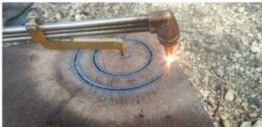
Gambar 6. Pemotongan pelat dengan oksiasetilin
