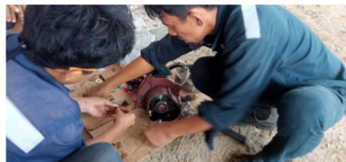
Gambar 14. Proses perakitan pada gearbox
