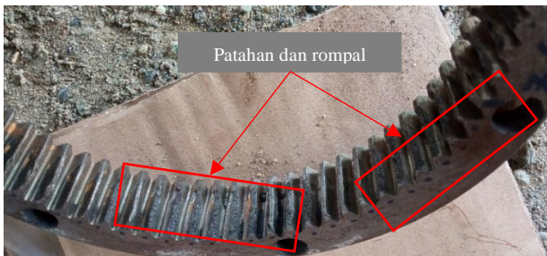
Gambar 4. Visualisasi cacat rompal/patahan roda gigi
