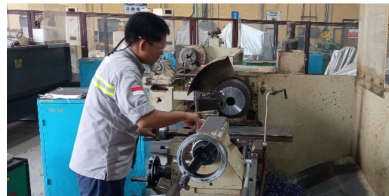
Gambar 7. Pembuatan diameter bakal dengan bubut
