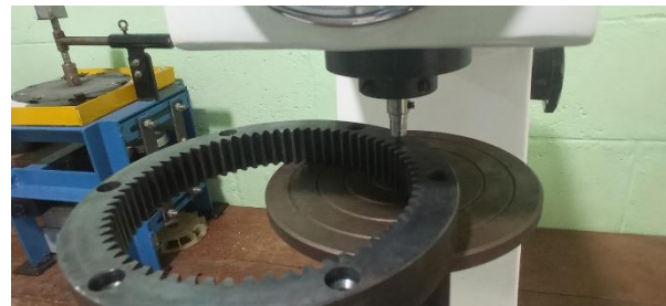
Gambar 11. Pengukuran kekerasan dengan Rockwell Hardness Tester
