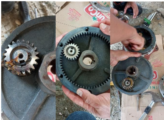
Gambar 13. Pembersihan dan pelumasan
