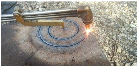
Gambar 6. Pemotongan pelat dengan oksiasetilin
