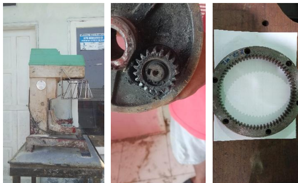
Gambar 2. Inspeksi mesin dan komponen yang rusak
