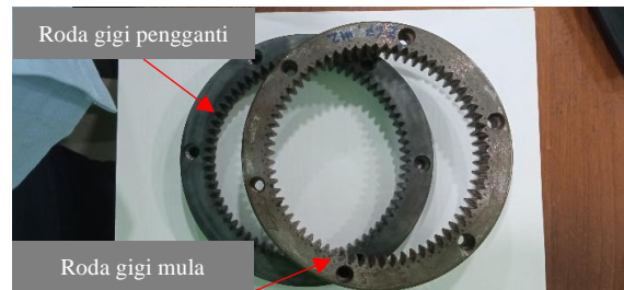
Gambar 10. Pengukuran dan pemeriksaan kesesuaian roda gigi pengganti
