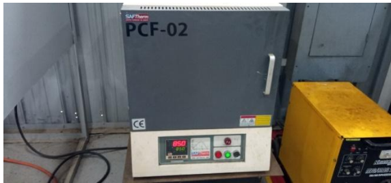
Gambar 9. Proses heat treatment hingga 850°C pada oven pemanas
