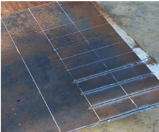
Gambar 5. Tahapan pemotongan plat dibuat untuk spesimen (Sumber: Dokumen, Pribadi)
