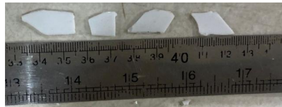
Gambar 11. Hasil cacahan plastik PP 2500 Rpm
