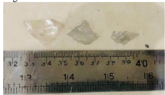
Gambar 2. Hasil cacahan plastik PET 3000 Rpm
