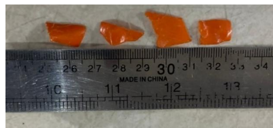
Gambar 6. Hasil cacahan plastik LDPE 3000 Rpm
