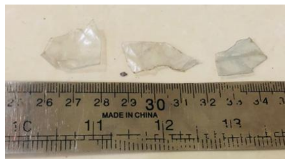
Gambar 3. Hasil cacahan plastik PET 2500 Rpm
