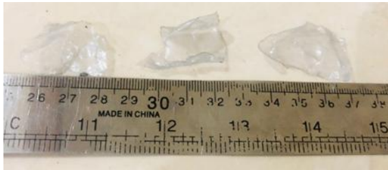
Gambar 4. Hasil cacahan plastik PET 2000 Rpm
