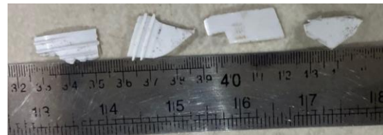
Gambar 10. Hasil cacahan plastik PP 3000 Rpm
