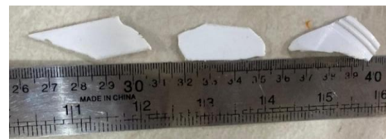
Gambar 12. Hasil cacahan plastik PP 2000 Rpm
