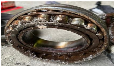
Gambar 8. Bearing yang rusak housing yang aus
