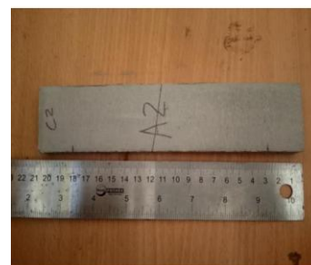
Gambar 2. Spesimen papan partikel semen
