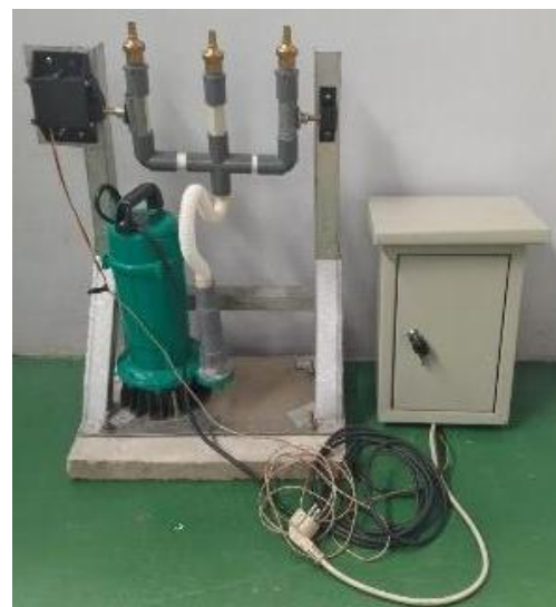
Gambar 5. Hasil konstruksi sistem air mancur
