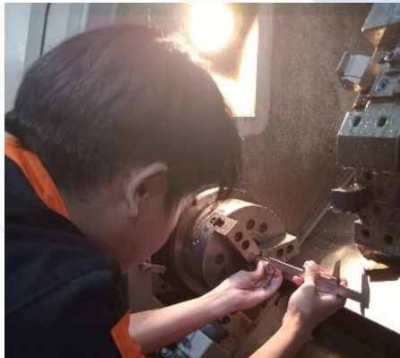
Gambar 4. 3 Pemasangan Benda Kerja
