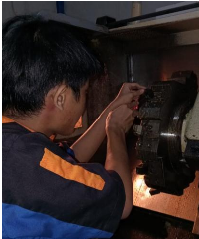
Gambar 4. 4 Pemasangan Alat Potong
