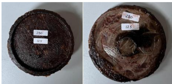
Gambar 16. Hasil Produk Suhu Injector 290°C dan Suhu Molding 125°C
