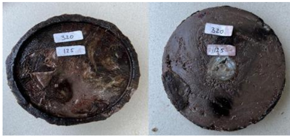
Gambar 18. Hasil Produk Suhu Injector 320°C dan Suhu Molding 125°C
