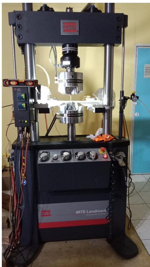
Gambar 5. Pengujian tarik statis
