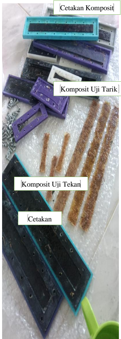
Gambar 4. Cetakan Komposit dan Spesimen hasil Cetakan untuk Pengujian Tarik, Tekan dan Pengujian Kekerasan
