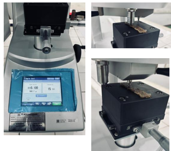
Gambar 6. Mesin Uji Kekerasan (kiri) dan Proses Uji Kekerasan (kanan atas dan kanan kiri)
