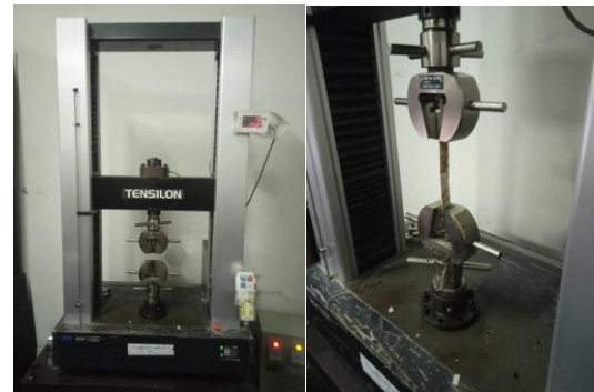
Gambar 5. Mesin Uji Tarik/Tekan (kiri) dan Proses Uji Tarik/Tekan (kanan)
