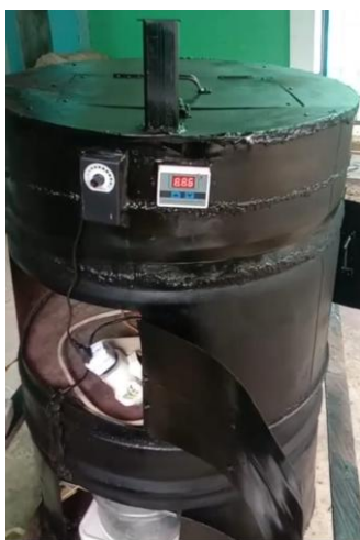
Gambar 3. Alat Pengering Biji Pala Menggunakan Kompor Listrik 1000W
