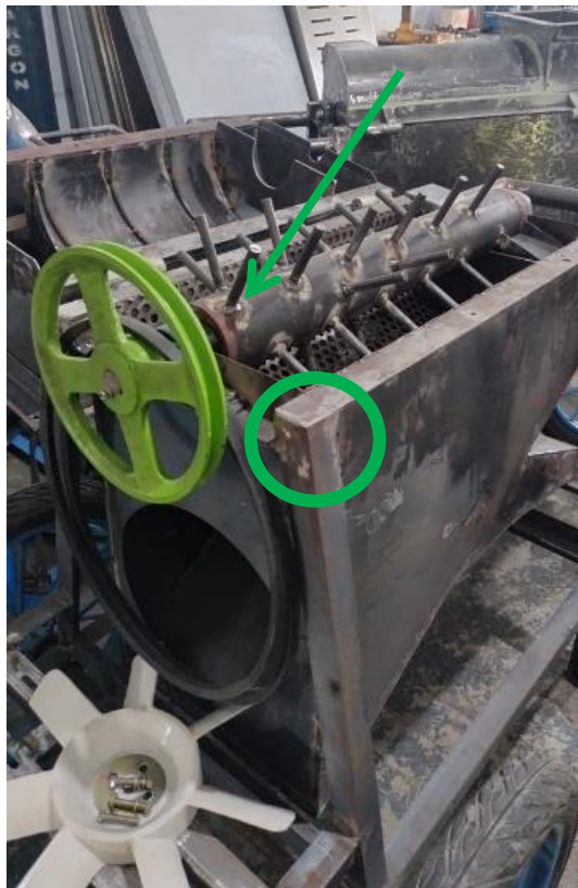
Gambar 3. Korosi pada Besi
