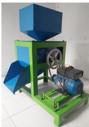
Gambar 3. Mesin pemecah kulit kemiri tipe impact rotary
