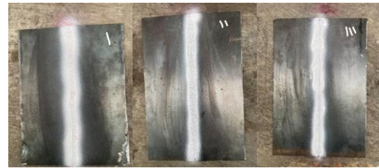
Gambar 5. Hasil pengujian dye penetrant hasil las dengan PWHT (a) 900°C (b) 1000°C (c) 1100°C
